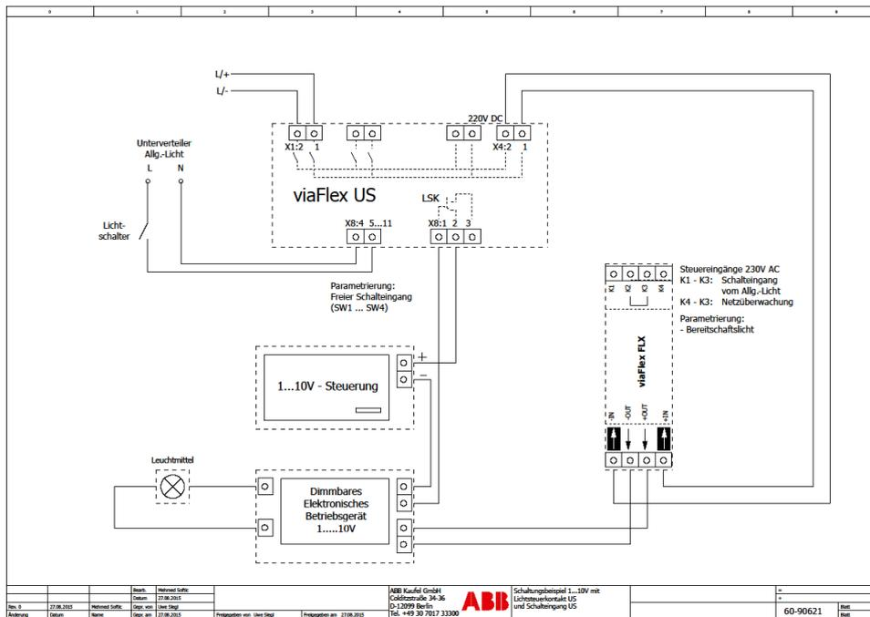
Bild 6 Schaltungsbeispiel 1...10V mit Lichtsteuerkontakt US und Schalteingang US
