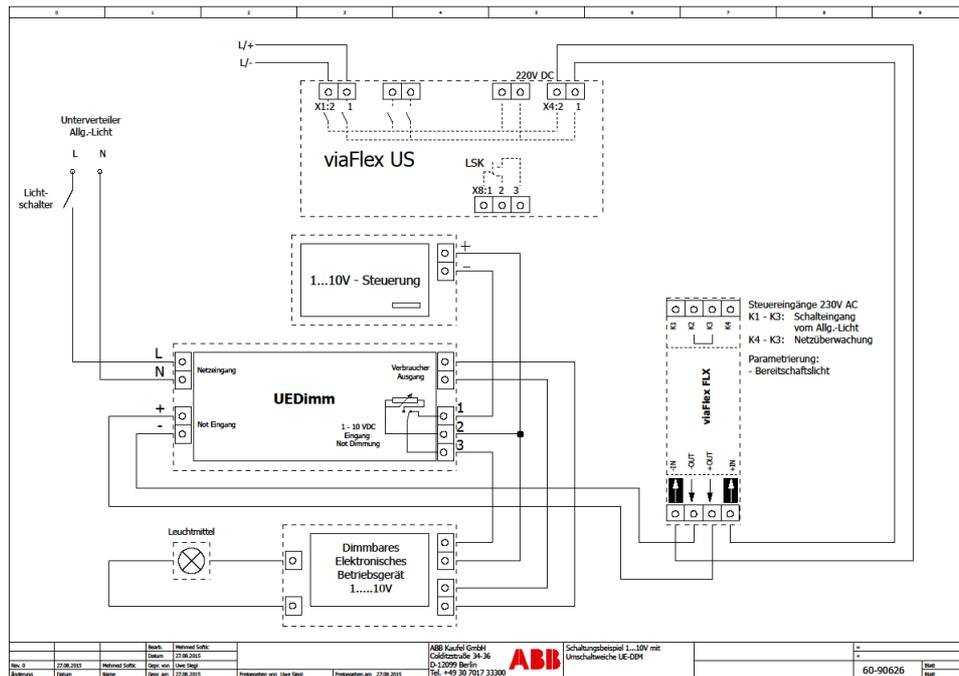
Bild 7 Schaltungsbeispiel 1...10V mit Umschaltweiche UE-DIM
